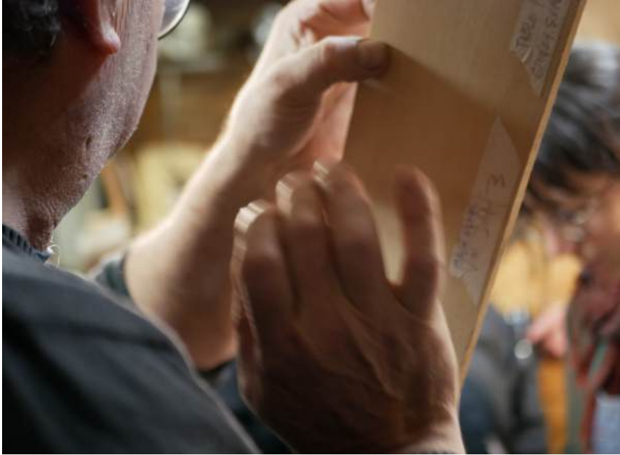
Pour sélectionner le bon bois, le luthier le fait sonner en le tapotant.
